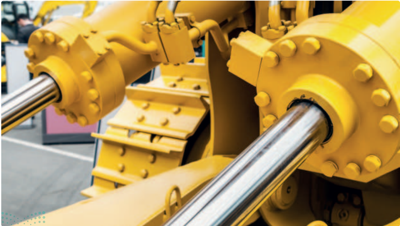
شكل 1.15: نظام مُشغّل هيدروليكي (مكبس) للآلات الثقيلة
