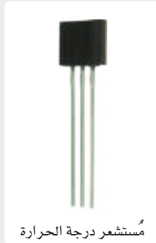
شكل 3.4: مُستشعر درجة الحرارة TMP36
