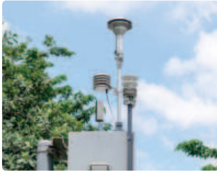
شكل 7.5: محطة جودة هواء ذكية
