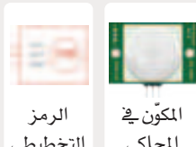
شكل 3.5: مُستشعر الحركة (PIR sensor)
