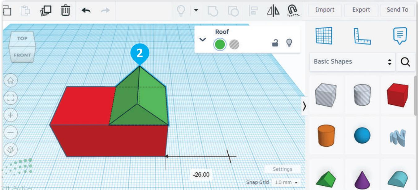
عليك الآن إنشاء سقفٍ آخر للمنزل، ولتنفيذ ذلك، ستستخدم أداة النسخ والمضاعفة (Duplicate and Replicate) التي ستنشئ نسخة جديدة من السقف أعلى السطح الأصلي مباشرة.
