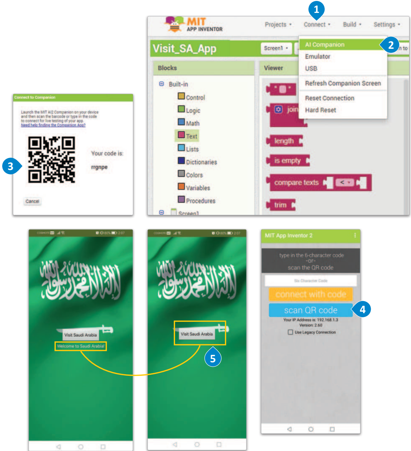
شكل 3.16: اختبار التطبيق باستخدام MIT AI2 Companion
