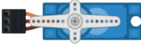
شكل 6.21: محرك السيرفو المصغر (كائن تينكر كاد)
