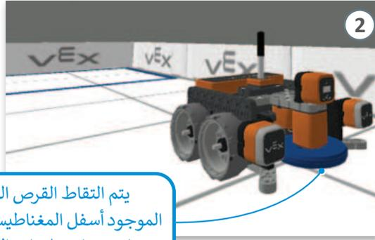
يتم التقاط القرص المعدني الموجود أسفل المغناطيس الكهربائي باستخدام تعليمات الالتقاط.
