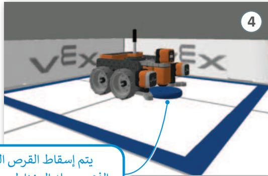
يتم إسقاط القرص المعدني الذي يحمله المغناطيس الكهربائي باستخدام تعليمات الإسقاط.
